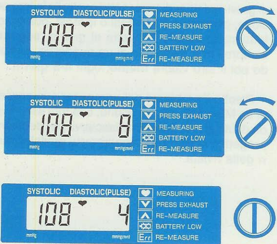
Fig.21 La vite posta sul pulsante della pompetta, la PRIMA VOLTA va tarata in modo che si adatti alla pressione atmosferica della zona. Se questa vite non è ben tarata, lo scarico dell'aria nella fascia avviene o troppo lentamente o troppo velocemente. La taratura risulterà perfetta quando apparirà un numero compreso tra 2 a 5 ( vedi fig.20 ).
